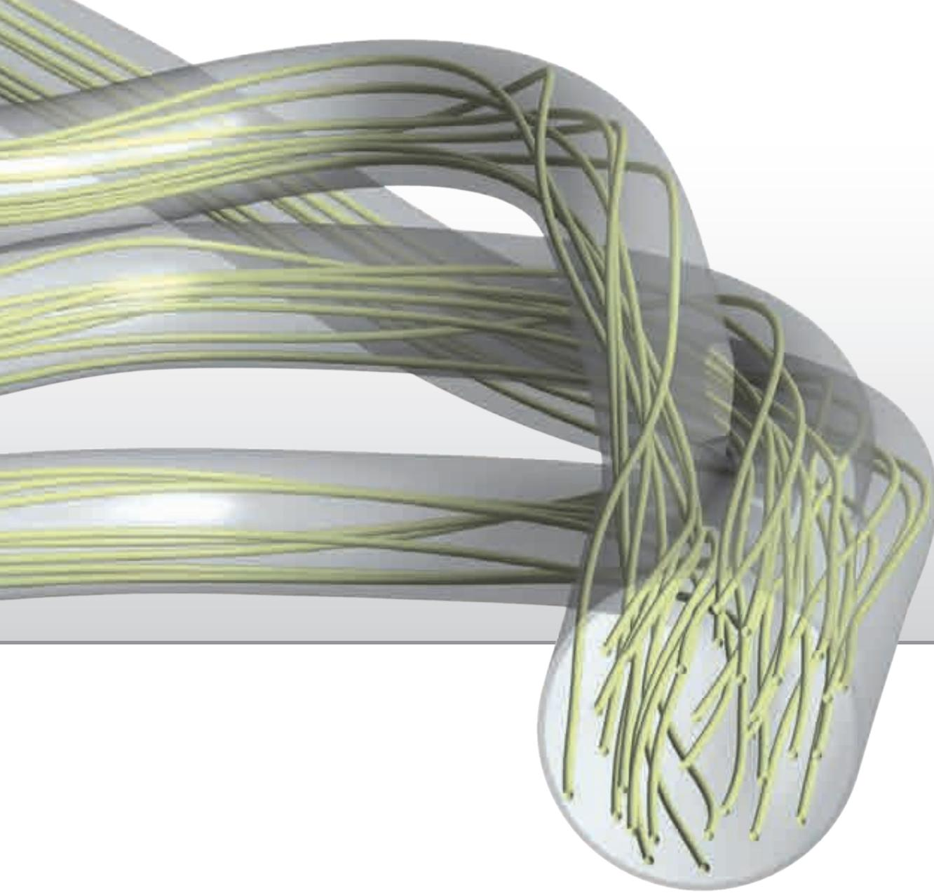
Komplexe Strömungsvorgänge sind häufig nicht sichtbar. Sie können jedoch durch realitätsnahe Computersimulationen (CFD) berechnet und visualisiert werden. Dadurch lassen sich ungünstige Strömungsverhältnisse erkennen, verstehen und optimieren.
